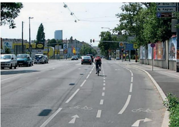
Abbildung 100: Vorsortierung des geradeausfahrenden und rechtsabbiegenden Radverkehrs vor einer Kreuzung
