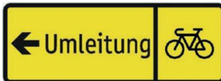
Abbildung 73: Hinweiszeichen für Umleitung des Radverkehrs; Format: mindestens 630 x 230 mm
