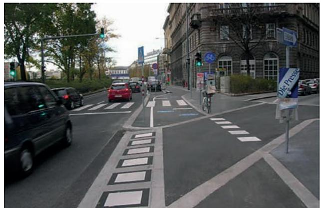
Abbildung 86: Straßenbegleitender Zweirichtungsradweg mit angehobener Radwegquerung
