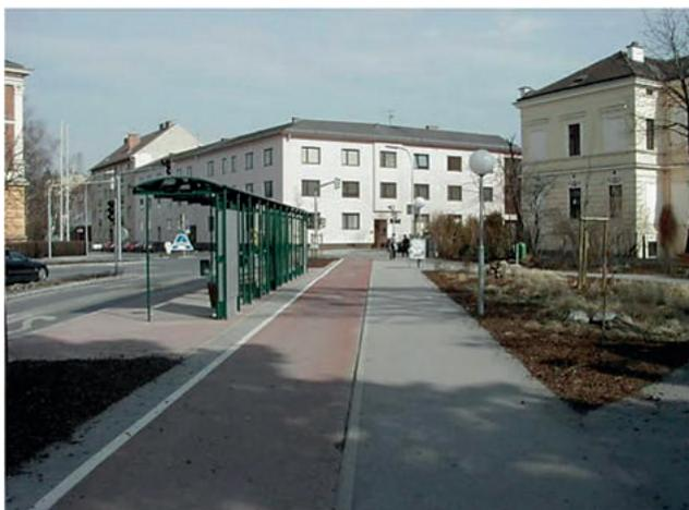
Abbildung 93: Bushaltestelle mit hinter der Fahrgastau Stellfläche durchgezogenem Radweg
