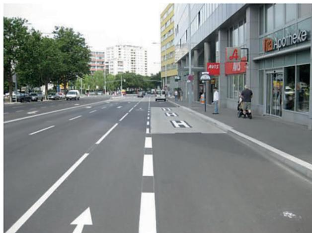
Abbildung 94: Durchgezogener Radfahrstreifen im Haltestellenbereich
