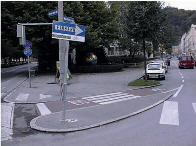
Abbildung 89: Ende eines Radfahrstreifens gegen die Einbahn mit Schutzinsel
