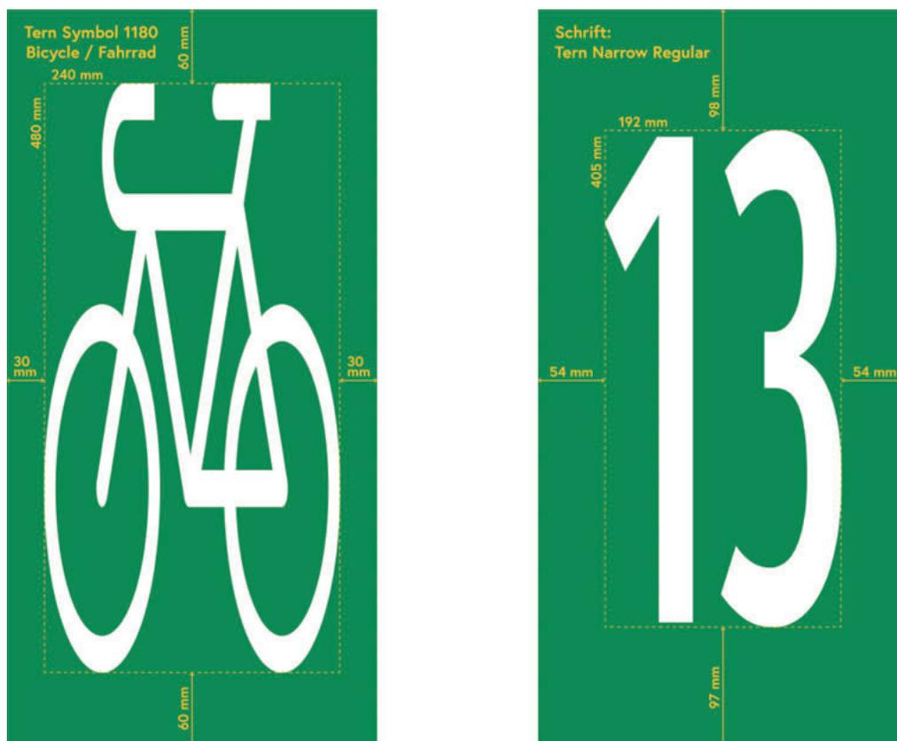
Abbildung 76: Form und Abmessungen der Elemente einer Bodenmarkierung zur Wegweisung (3/3)
