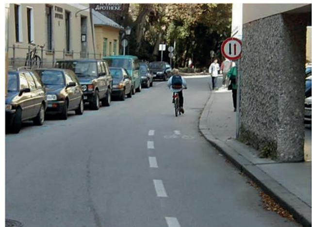
Abbildung 92: Unterbrechung eines Radfahrstreifens gegen die Einbahn bei einer Engstelle
