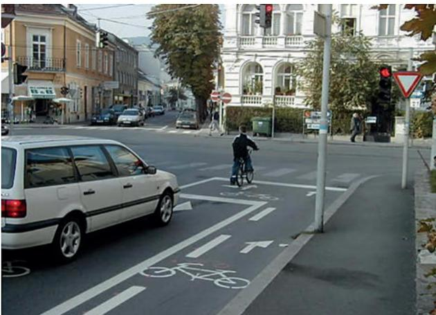
Abbildung 98: Aufgeweiteter Radfahrstreifen vor Kreuzung mit unterbrochenen Linien (ermöglichen vorzeitigen Fahrstreifenwechsel für den Radverkehr)
